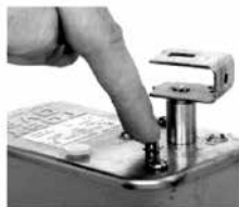
1. Ενεργοποίηση της βαλβίδας εξαγωγής με επανειλημμένες πιέσεις πάνω στο ζ-γκλέρ (μοχλός οπλίσεως)
